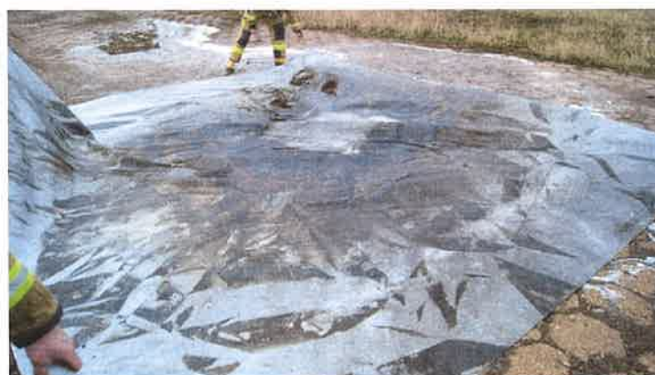
Fot. nr 26 Płachta Padtex typu PAD-CFB-M-1 po jednym użyciu i przemyciu wodą (Źródło: CNBOP-PIB)
