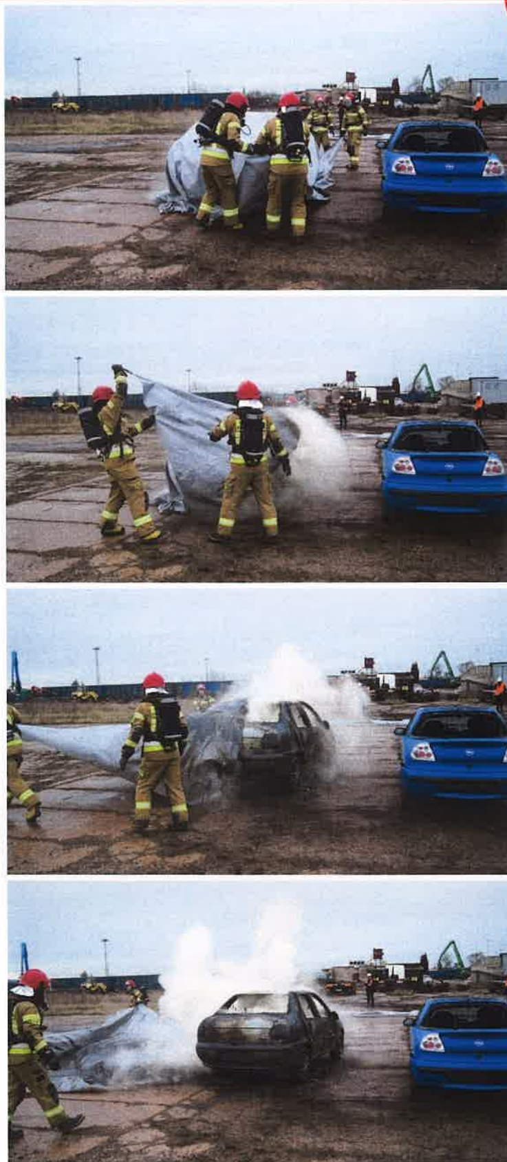
Fot. nr 21 - 24 Zdejmowanie płachty Padtex typu PAD-CFB-M-1 (Źródło: CNBOP-PIB)
