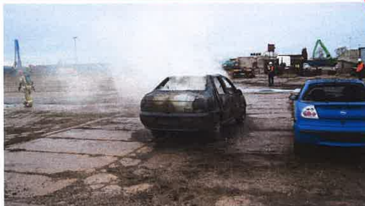
Fot. nr 25 Pojazd po zdjęciu płachty Padtex typu PAD-CFB-M-1 (Źródło: CNBOP-PIB)
