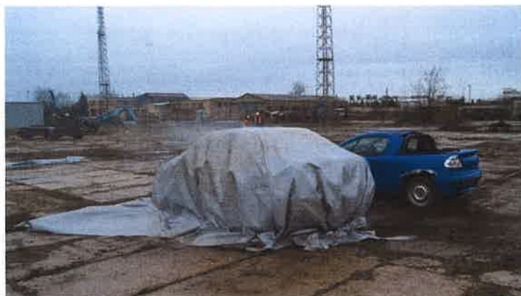
Fot. nr 19 Pojazd przykryty samochodową płachtą gaśniczą Padtex typu PAD-CFB-M-1 (Źródło: CNBOP-PIB)
