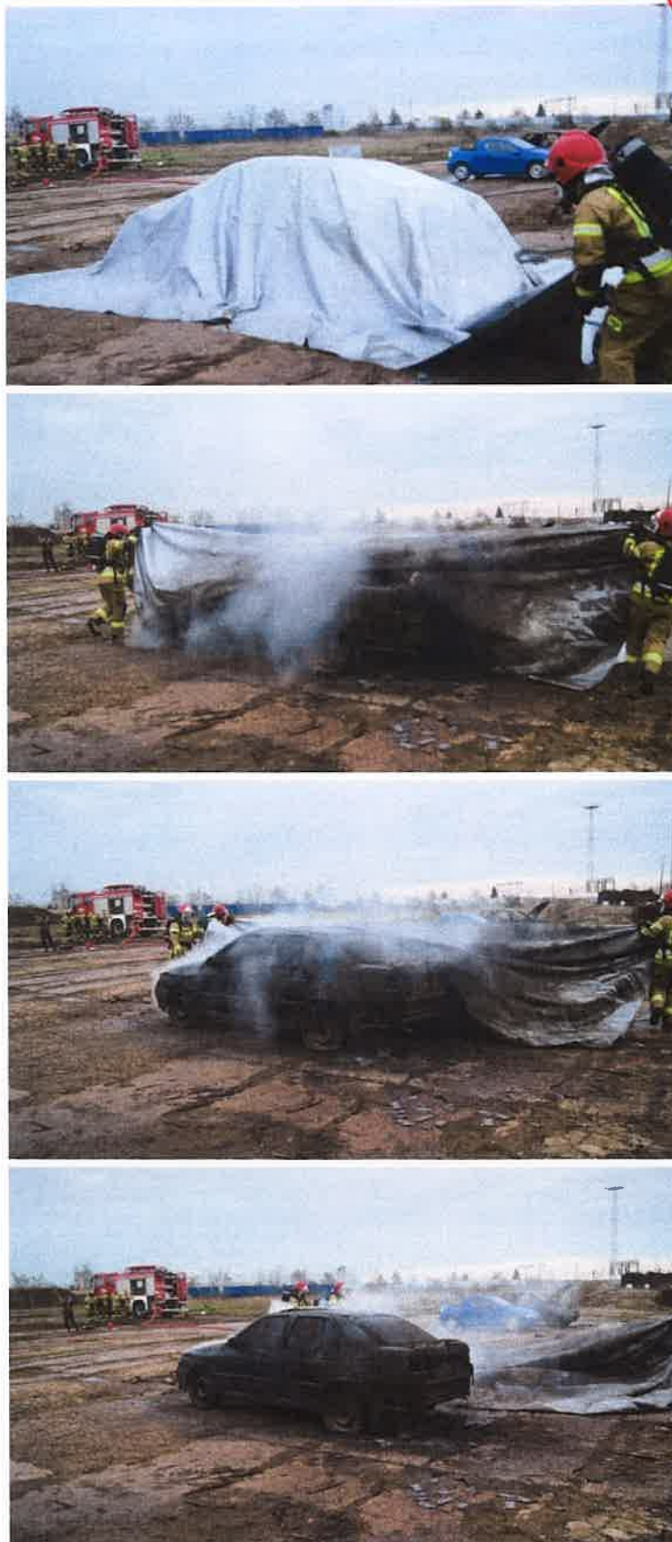
Fot. nr 36 - 39 Zdejmowanie płachty Padtex typu PAD-CFB-M-1 (Źródło: CNBOP-PIB)
