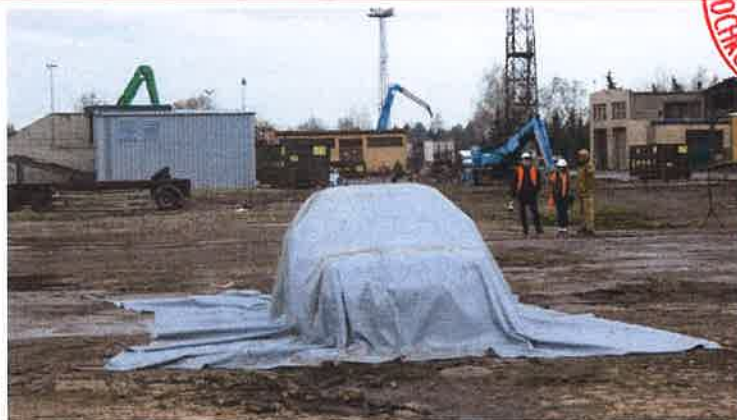
Fot. nr 40 Pojazd przykryty samochodową płachtą gaśniczą Padtex typu PAD-CFB-M-1 (Źródło: CNBOP-PIB)
