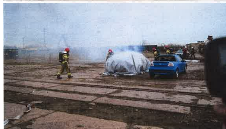
Fot. nr 15- 18 Nakładanie płachty Padtex typu PAD-CFB-M-1 na płonący pojazd (Źródło: CNBOP-PIB)
