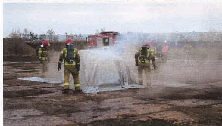
Fot. nr 32 - 35 Nakładanie płachty Padtex typu PAD-CFB-M-1 na płonący pojazd (Źródło: CNBOP-PIB)
