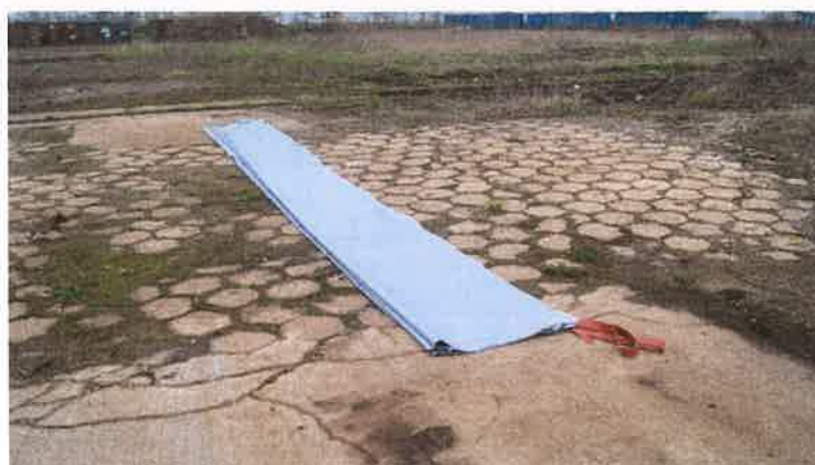
Fot. nr 2 Samochodowa płachta gaśnicza Padtex typu PAD-CFB-M-1 w rozmiarze 6 x 8m
