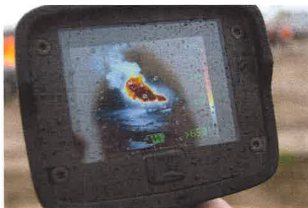
Fot. nr 20 Pomiar temperatury kamerą termowizyjną 3M™ Scott™ V320 (Źródło: CNBOP-PIB)
