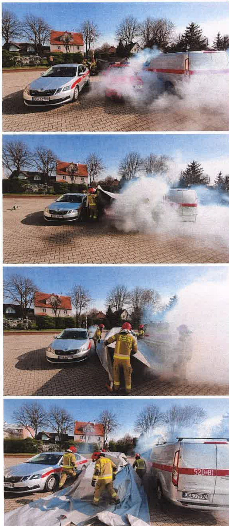
Fot. nr 3 - 6 Nakładanie płachty Padtex typu PAD-CFB-M-1 na pojazd zaparkowany na placu wewnętrznym JRG Oława, (Źródło: JRG Oława)
