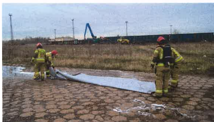
Fot. nr 27 Płachta Padtex typu PAD-CFB-M-1 przygotowywana do ponownego użycia (Źródło: CNBOP-PIB)
